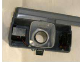
Figure 4: parte superiore della trappola Gravid assemblata.
