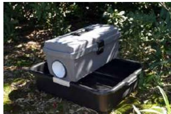
Figure 5: trappola Gravid assemblata e posizionata.
